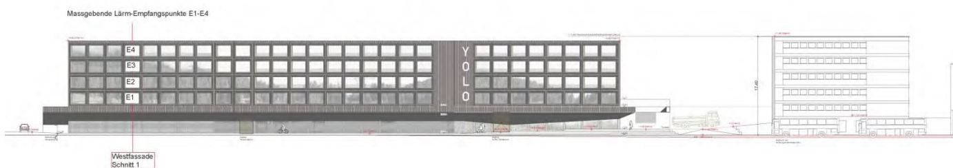
Massgebende Lärm-Empfangspunkte E1 – E4 im 1. bis 4. Obergeschoss
