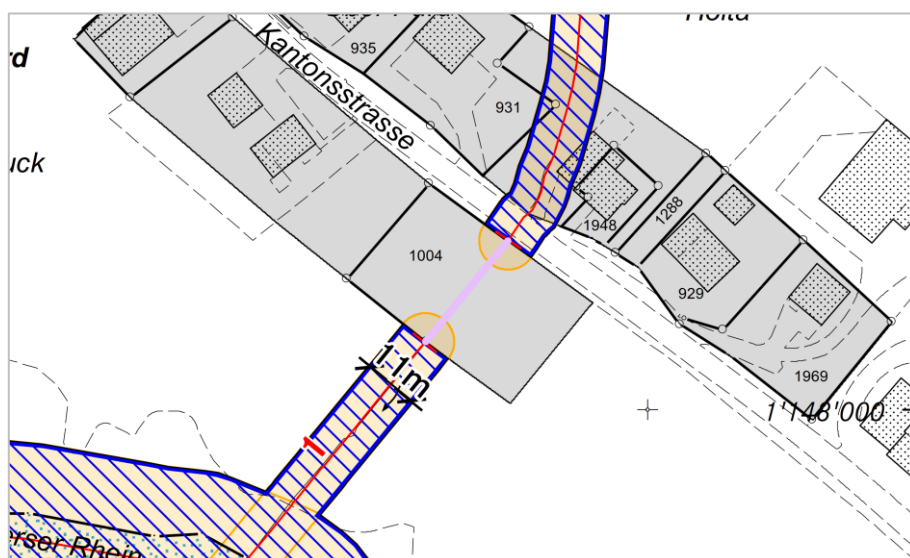
Abb. 2: Vorläufiger Verzicht auf Festlegung Gewässerraum bei der Siedlung Ober Pürd
