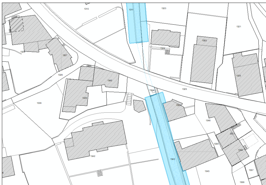
Illustrazione 9: Rappresentazione propria: Nei pressi della Casa comunale si rinuncia alla determinazione dello spazio riservato alle acque a causa di una copertura e messa in galleria del corso d'acqua.
