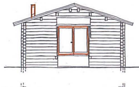
Bestehende Öffnungen (Fenster, Stall- und Heuraumtore) sind zu verwenden. Sie können auf der Innenseite verglast werden.
